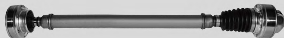
Карданний вал (за технологією зварювання тертям)
